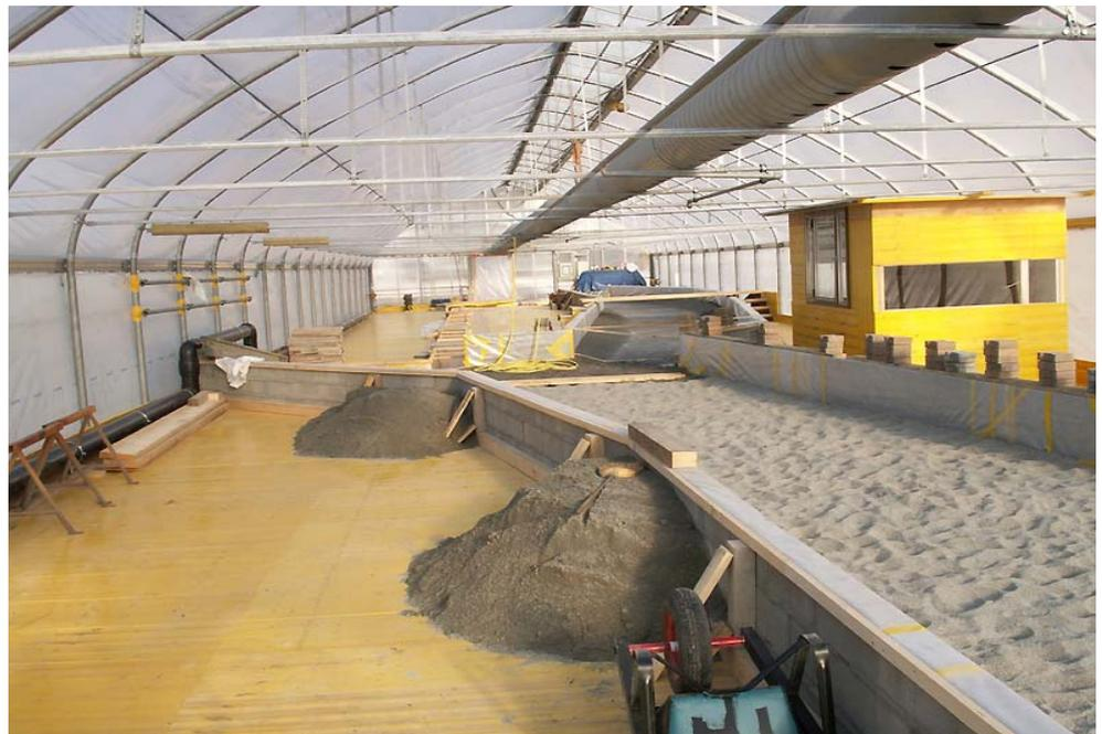
Grundsätzlich wird bei der 3. Rhonekorrektur der Mündungsbereich der Vispa in die Rhone stark aufgeweitet und gleichzeitig renaturiert. Die Experimente im Modell sollen das Verhalten der Flusssohle, die Stabilität des Ufers, die Auswirkung auf den Wasserspiegel und die Funktionalität von sogenannten Kippelementen, die bei Hochwasser zum Einsatz kommen, untersuchen. Die Ufer werden gemäss Planung auf einer Län-
