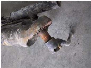
Defekte Anhängerkupplung eines Kompressors
