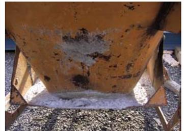
Ungereinigter Betonkübel mit Betonrückständen
