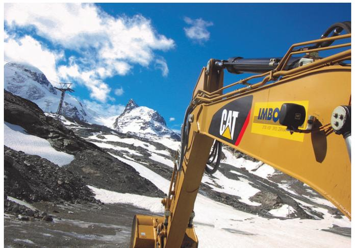
lediglich Gewichte von 2 Tonnen transportieren. Der für die Baustelle notwendige Raupenbagger wiegt aber 24 Tonnen - und auch in Einzelteile zerlegt reicht's nicht, denn das schwerste Einzelteil hat ein Gewicht von 5 Tonnen. Also blieb einzig der gefährliche Weg - Meter für Meter - über den Gletscher. Dazu musste der Bagger mit speziellen Gletscher-raupen ausgestattet werden.
