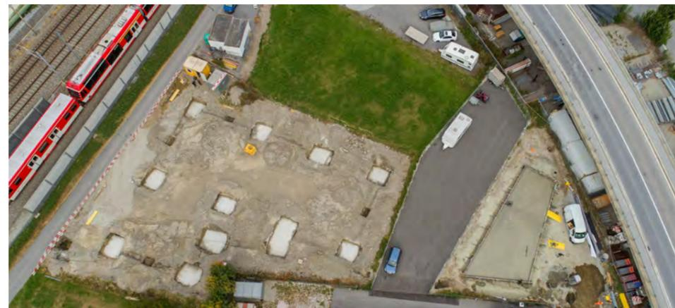
Für die Eigentümer der Wäscherei Heinzmann in Raron erstellt die Ulrich Imboden AG nahe der Brücke Eyholz zwei Bodenplatten für die Realisierung von zwei Lagerhallen. Die eine Halle weist eine Grundfläche von 150 m<sup>2</sup> auf und soll dereinst rro und der Wäscherei Heinzmann dienen. Die Arbeiten dazu
