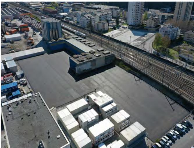
Für die Lonza AG wird der neue Lonza-Parkplatz PP 01 im Umfang von rund 7'000 m<sup>2</sup> fertiggestellt (Foto links). Hier wurde die Foundationsschicht neu erstellt und anschliessend ein zweischichtiger Sickerbelag neu eingebaut.
